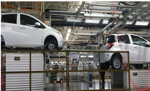
图 1-5 窄滑板摩擦式输送线
