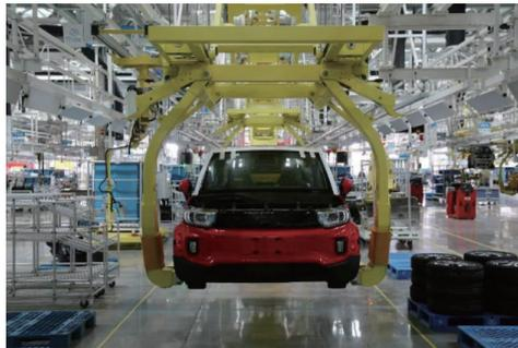
图 1-6 空中输送段摩擦式输送机
